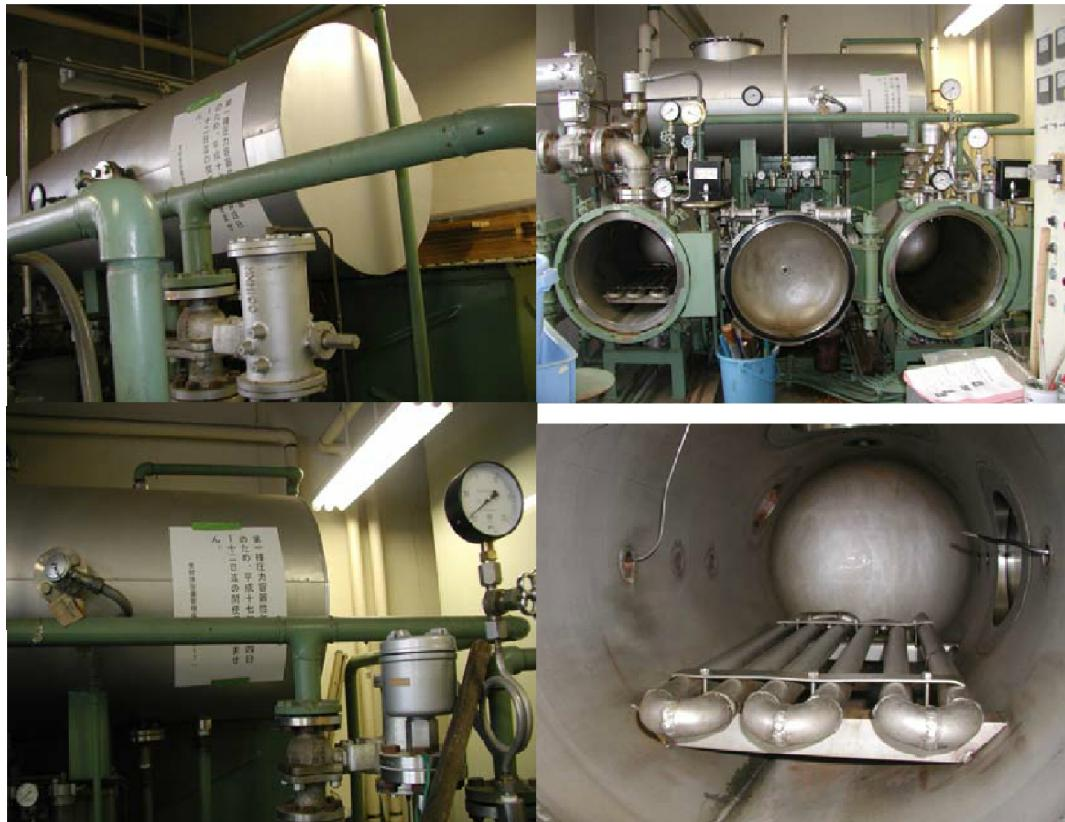
この実験設備は、高温、高圧、低温、減圧などを繰り返し、樹木などの樹液を抽出し、成分として回収する装置だ。実験用ながらこの装置では 200 度弱の温度上昇に耐えられると聞いた。これだけのものがあれば、サーモウッドの製品かも可能であり、うらやましい限りだ。このような装置があることを民間に更に PR し、適正な実験価格で、民間の研究に更なる協力を願う次第だ。
