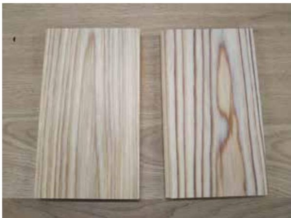
ホウ酸・リン酸系の薬剤で不燃処理した木材は薬剤の高い吸湿性が原因の溶脱により木材の表面がベタベタに湿ったり、薬剤の結晶で木材の表面が白くなる白華現象を起こします。エフネンノン白華は、従来の不燃木材の欠点であった過剰な吸湿性による溶脱・白華を、限界まで抑えた低吸湿性の不燃木材です。
