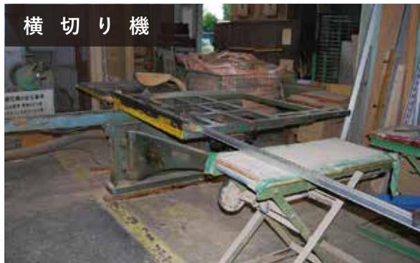
刃物が固定され、テーブルが移動する機械。材料の長さカット、正寸カット時に使用する。
