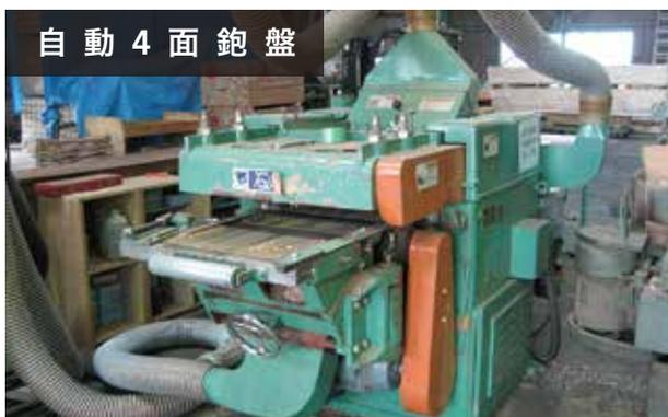
4つの加工軸を使用して1度の切削工程で木材の4面を同時に削ったり、ムラや歪みを同時に取り除くモルダーの刃物と併用し面加工・実加工などの加工を行う。
