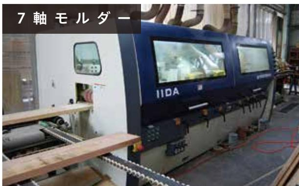
7つの加工軸で木材の上下左右の4面を正確な寸法決めを行い、様々な形状の刃物で、造作材の溝加工・面加工・フローリングや羽目板の本実加工やモールディング加工など、多様な断面形状の加工を行う。
