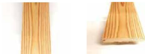
不燃木材とはホウ酸系(ホウ砂・ホウ酸など)やリン酸系(リン酸アンモニウムなど)等の不燃薬剤を木材に注入して製造される建築材料で、建築基準法により不燃、準不燃、難燃に区分されています。
