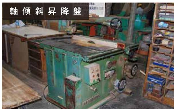
加工形状に合わせた刃物により、溝加工や4隅の面取り加工、またテーパ加工ができる。造作材の加工や見切材、またフローリングやデッキ材の再加工時の製材にも使用する。
