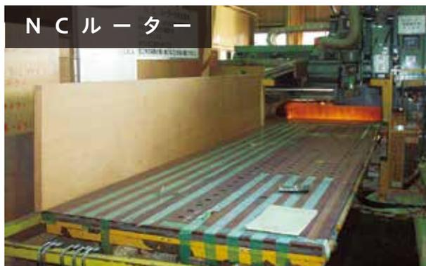
動作をNCの形式の数値にプログラム化して、階段のプレカット加工・R切り抜き加工・穴あけ加工・ディッピング加工・表面削り加工を行う、非常に寸法精度の高い機械。
