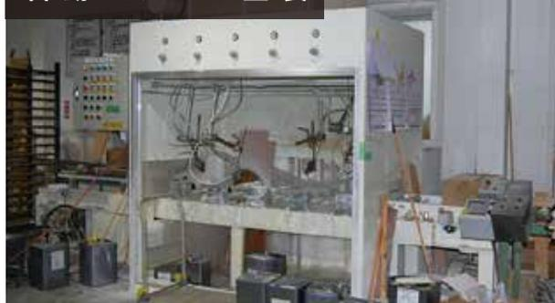
塗料にコンプレッサーの圧縮空気を使ってスプレーガンで噴霧塗装を行う。透明塗料を塗るだけではなく、カラーイングによる色の調整も行う。
