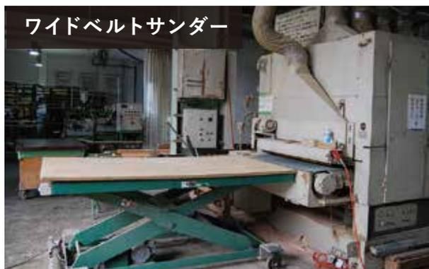
表面の厚さ決めや仕上げを行う機械。巾が1200mmまでサンダー掛けが可能で、造作材や化粧合板のサンダー仕上げから幅広カウンターの厚さ決め、仕上げを行う。
