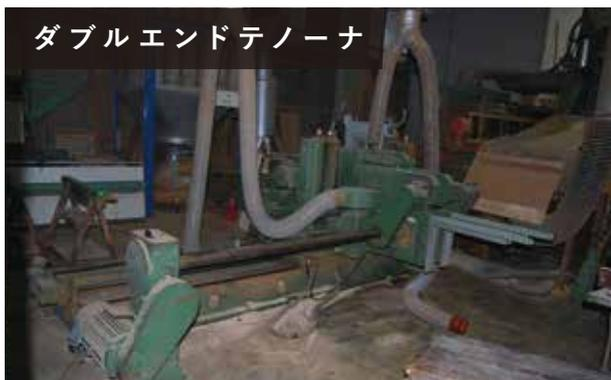
長さ方向両端のほぞ取り、切断、溝加工を行う機械でフローリングの両木口のエンドマッチ加工を行う。
